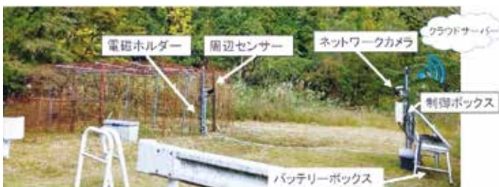
遠隔監視操作システムの概要
