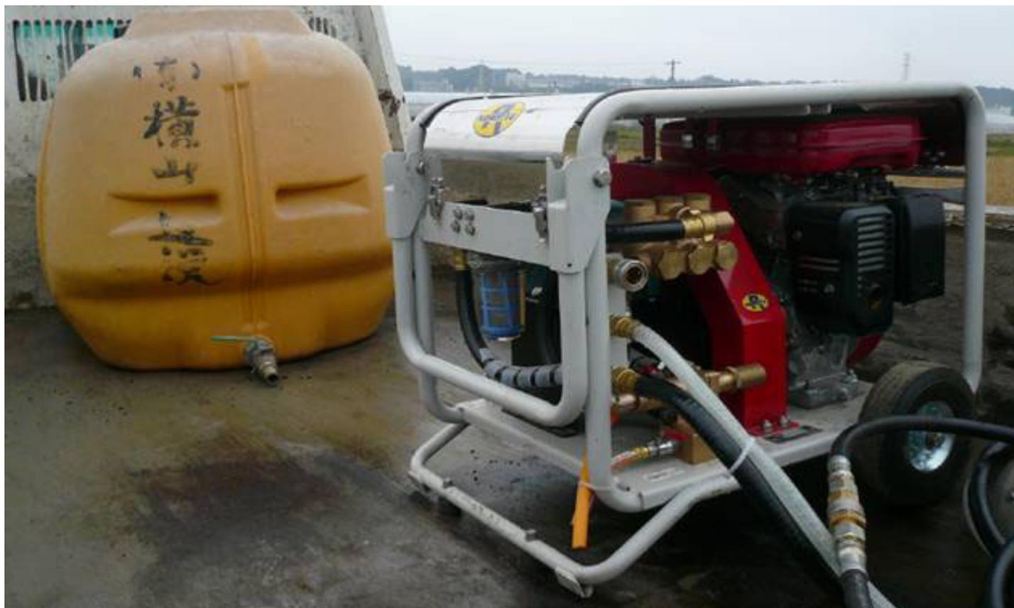
写真6: エンジン式高圧水洗機と1000ℓ水タンク
